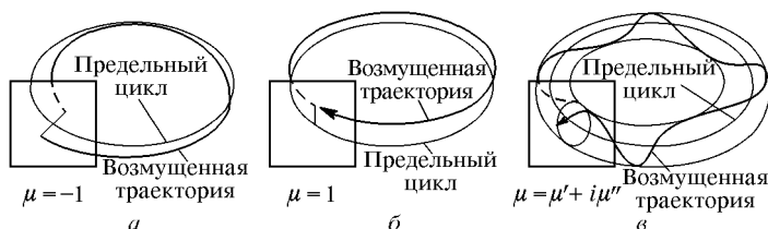
Рис. 14.5. Поведение близкой к предельному циклу траектории на трех границах треугольника устойчивости
