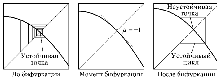
Рис. 14.6. Бифуркация удвоения периода: мягкая, нормальная, суперкритическая
